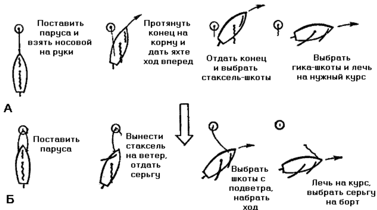
Рис. 122. Отход от буя или бочки А. — если яхта стояла на носовом, закрепленном на бочке, конце; Б — если яхта стояла на носовом конце, заложенном серьгой
