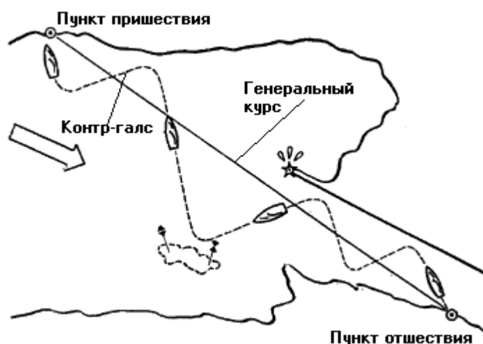
Рис. 107. Лавировка в узкост и в открытом бассейне
