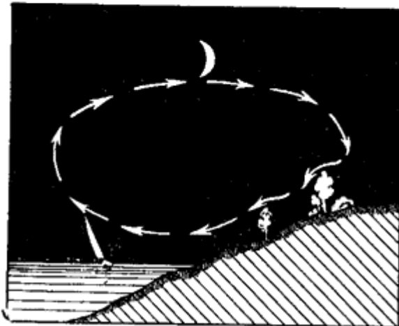
Рис. 88. Схема дневного и ночного бризов
