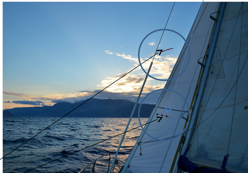
Колдунчики на передней кромке (шкаторине) паруса показывают правильность установки паруса.
