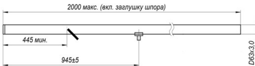
Чертеж Ф.4. Нижняя секция мачты класса «Луч - М»
