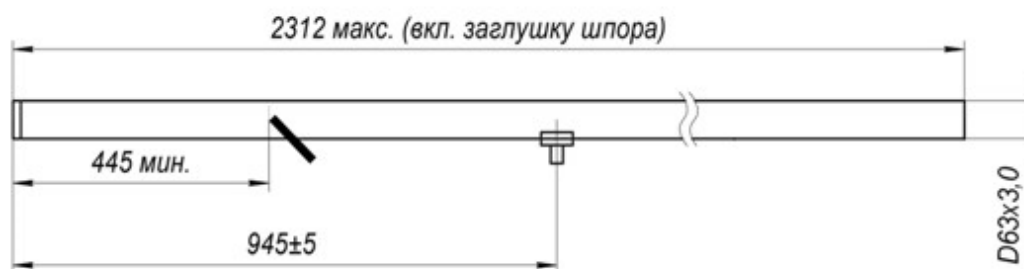
Чертеж Ф.3. Нижняя секция мачты класса «Луч - Радиал»
